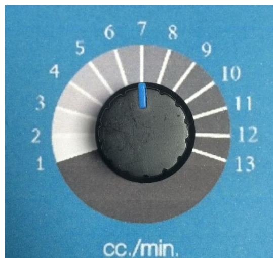
รูปที่ 5 แสดงปุ่มปรับการตั้งค่า 1.0 – 13.0 ซีซี/นาที Fig.5 adjust volume of Chlorine knop 1.0 – 13.0 cc/min
